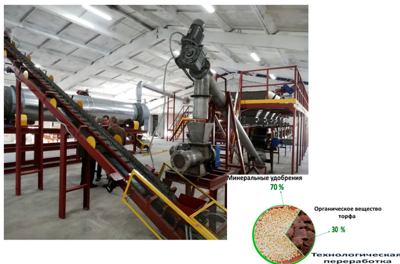
Рис. 10. Экспериментальная пилотная установка по производству комплексных органо-минеральных гранулированных удобрений пролонгированного действия на основе торфа, 2019 г.
