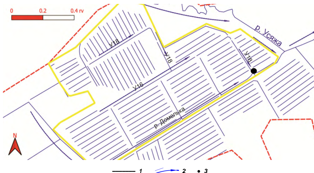
Рис. 5. Современная гидрологическая сеть участка в системе каналов У16–У18: 1 – участок в системе каналов У16–У18 торфяного месторождения Усяж; 2 – линии стекания болотных вод; 3 – насосная станция
