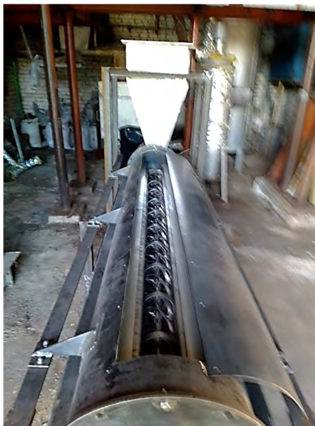
Рис. 6. Опытная установка для термической переработки горючих сланцев с открытой верхней крышкой
